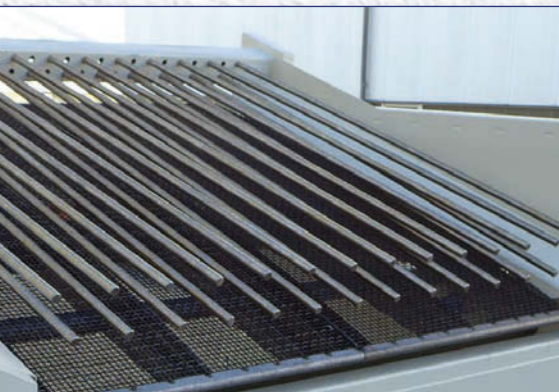
Stangensizer zur Grobabscheidung
