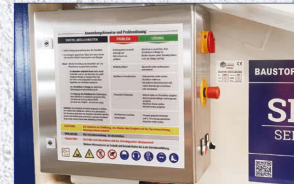
Schaltschrank mit Kurzanleitung
