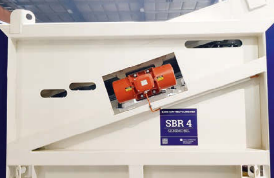
Direkterregung des Siebdecks
